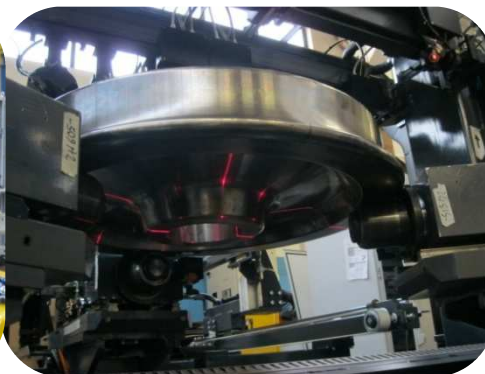
Stazione di misura off-line per ruote monoblocco a superficie lucida/finita
