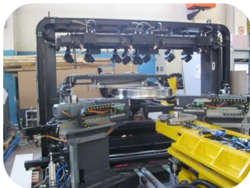
Stazione di misura off-line per ruote monoblocco a superficie lucida/finita
