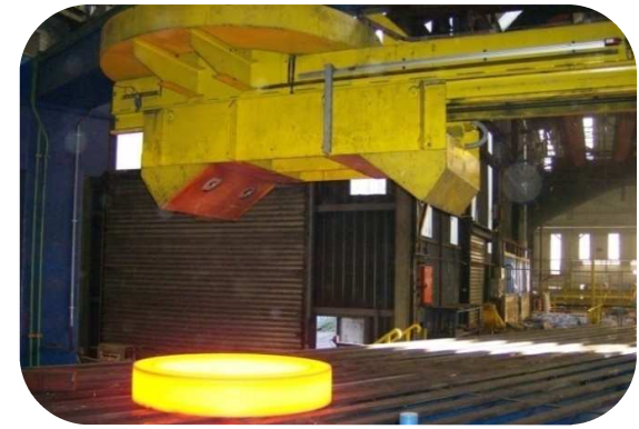
Misura in linea a caldo di anelli medi e grandi
